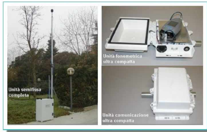
Figura 2 – Unità per acquisizioni su lungo e su breve periodo
